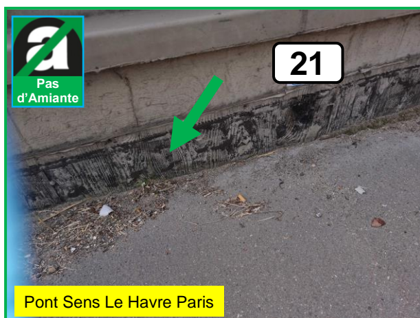
P23 Mastics bitumineuse câbles de suspension : Absence de fibre d'Amiante
