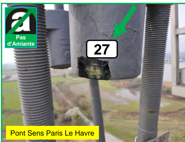
P29 Peinture + Sous couche Armoire : Présence de fibre d'Amiante Chrysotile
